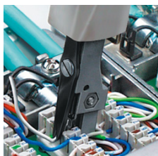
Опрессовка и резание кабеля за один рабочий ход
